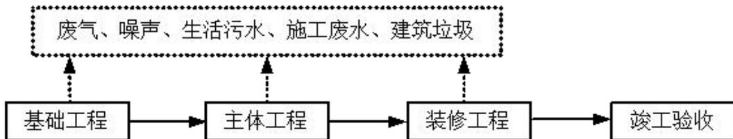
图 5-1 施工期工艺流程及产排污环节图
