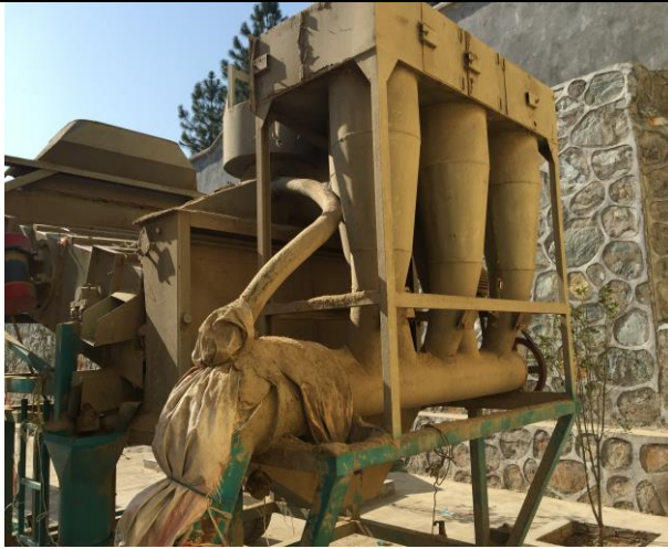
①成事粮油仓库除杂机布袋除尘器安装位置 ②输送带除尘系统安装位置示意
