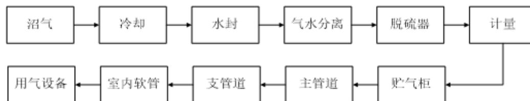
图 3.2-6 沼气净化及输配工艺
