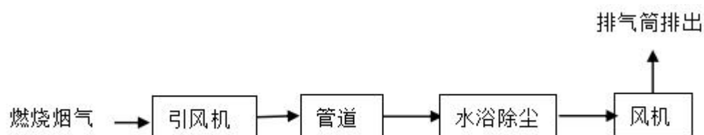
图 7-1 锅炉烟气处理工艺流程
